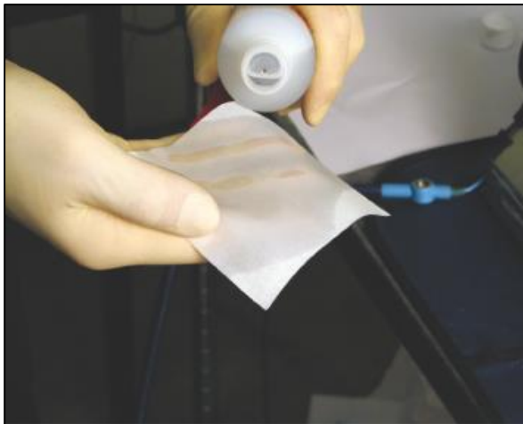
Step.9) Cleaner K를 패드에 도포 후 드럼 표면 청소 (2표면 청소 후 새로운 패드 사용, 좌→우 방향)
