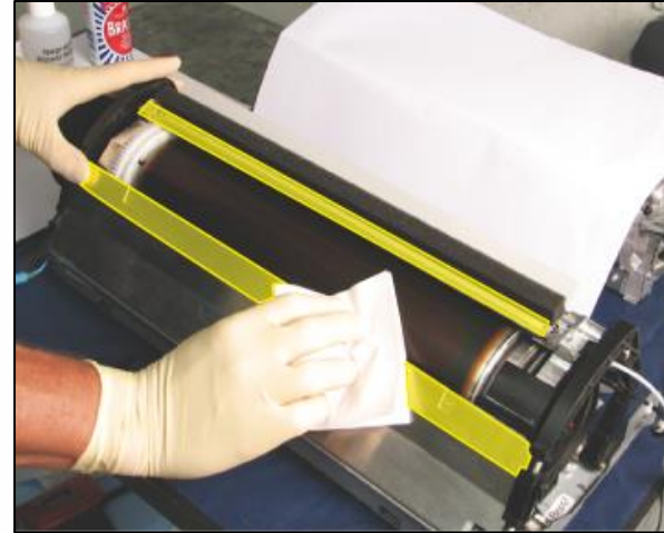
Step.8) 새로운 패드(브라소 X) 드럼 커버 청소
