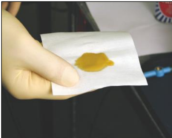
Step.5) 3면 청소 후 새로운 패드에 브라스 도포하여 사용
